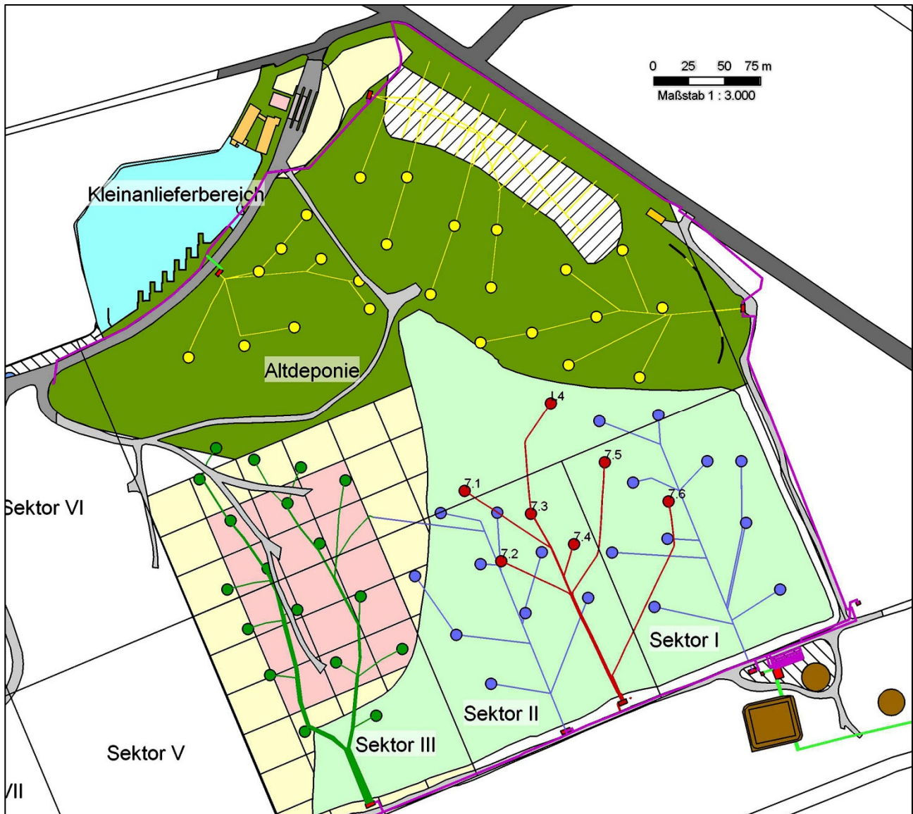
Abb. 3 - 28: Bestand der aktiven Gasbrunnen (die rot gekennzeichnete Gruppe sind die 2014 erstellten Gasbrunnen, die auf Tiefenentgastung umgestellt wurden)
